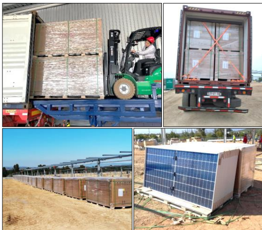
图 1. 182 组件采用侧立的包装方式，最大化利用集装箱空间又留有约 10cm 装卸余量，组件在项目现场可平稳放置
